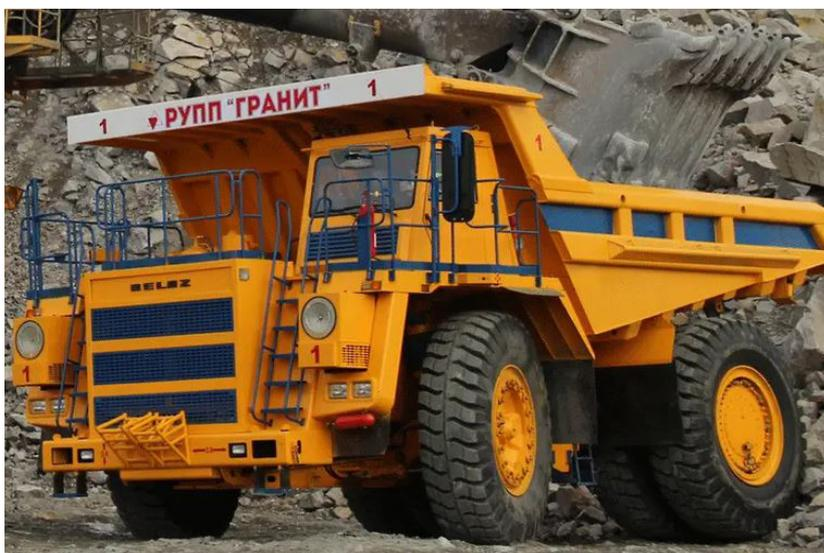
«Это первый в мире с такой грузоподъемностью самосвал, который работает чисто на газу, на сжиженном природном газе. Бак объемом 1,5 тыс. литров – хватает на полную смену работы от 12 до 14 часов в зависимости от условий эксплуатации. Экономия составляет до 30% на топливе за счет разницы стоимости дизельного и газового топлива», – сказал он на XXX Международной выставке технологий горных разработок «Уголь России и майнинг» в Новокузнецке (цитата по ТАСС).
